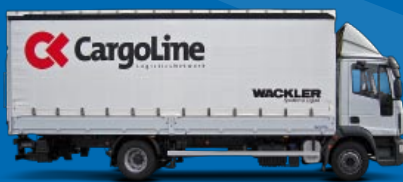
» Schiebeplanen-Aufbau leichte Baureihe mit Ladebordwand und Planenbeschriftung
