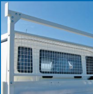
» Handwerkerpritsche, Stirnwand erhöht, vergitterter Gerüstbock
