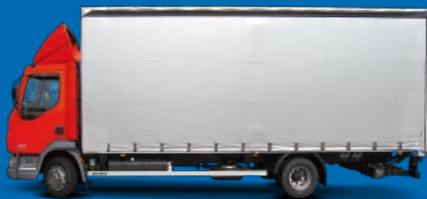
» Curtainsider-Aufbau leichte Baureihe mit Direktspannern an der Plane, Ladebordwand
