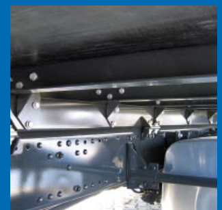
» Unterbau geschraubt, alle Teile sandgestrahlt und decklackiert
