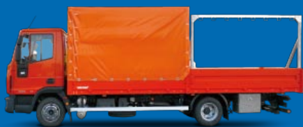
» Handwerker-Pritschenaufbau mit halben Verdeck und Gerüstbock nach Kundenwunsch
