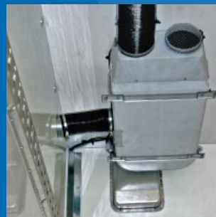
» Heizung zur Temperierung eines Koffers zum Blumentransport
