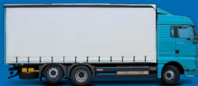
» Curtainsider-Aufbau der schweren Baureihe mit Portaltüren am Heck
