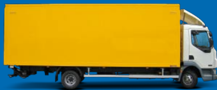
» Backwarenkoffer mit Kiemenlüftung, Ladebordwand, lebensmittelechter Auskleidung
